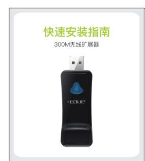
1.请将您购买的产品插入可供电的USB接口(如手机充电器或者移动电源 USB口、电脑或者电视的USB端口),系统灯亮起后熄灭,此过程表示扩 展器正在启动,约15秒完全启动。
